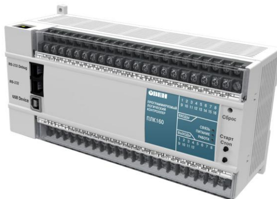
Рисунок 11 – Программируемый логический контроллер ОВЕН ПЛК160
