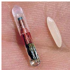
Рисунок 3 – Размеры микрочипа в сравнении с рисовым зерном
