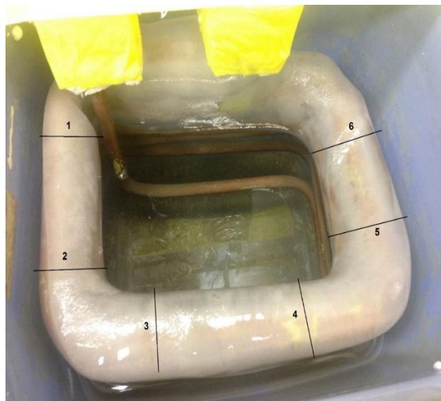
Рисунок 11 – схема расположения трубки в камере испарителя и места замеров толщины льда
