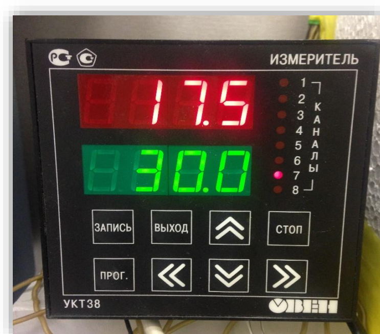
Рисунок 8 - Устройство контроля температуры восьмиканальное ОВЕН УКТ38-Щ4
