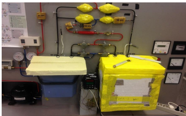
Рисунок 6 – Расположение ключевых термодпар на экспериментальном стенде
