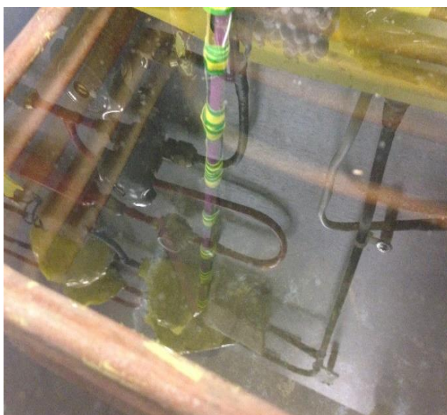
Рисунок 10 – схема расположения термопар в камере испарителя
