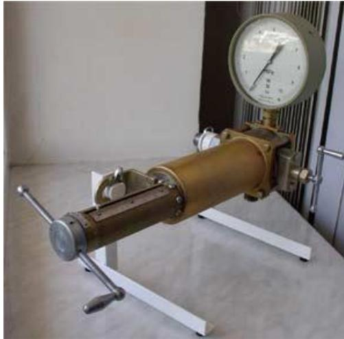
Рисунок 2.5 - Устройство для определения свободного газа (УОСГ 100 СКП) [34]
