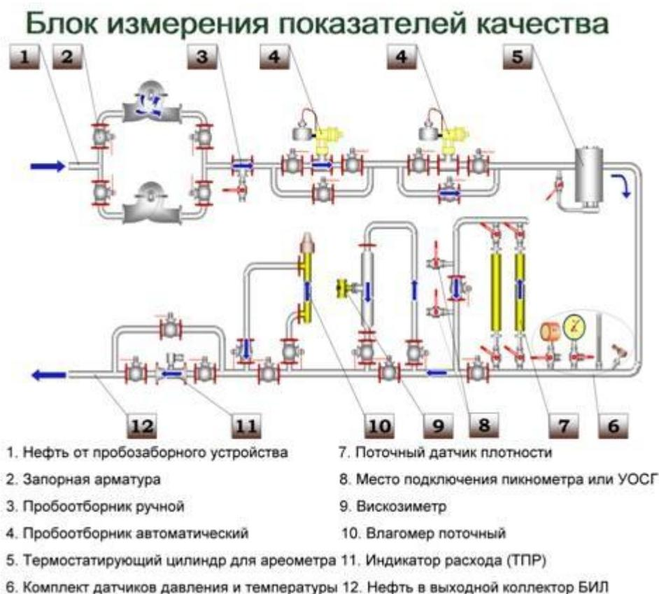
Рисунок 3.5 – Типовая технологическая схема БИК [32 ]
