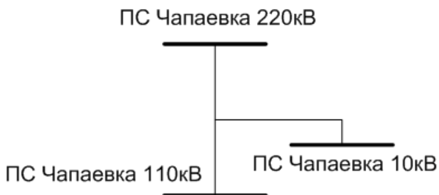
Рисунок 14 - Скелетная схема эквивалента энергорайона
