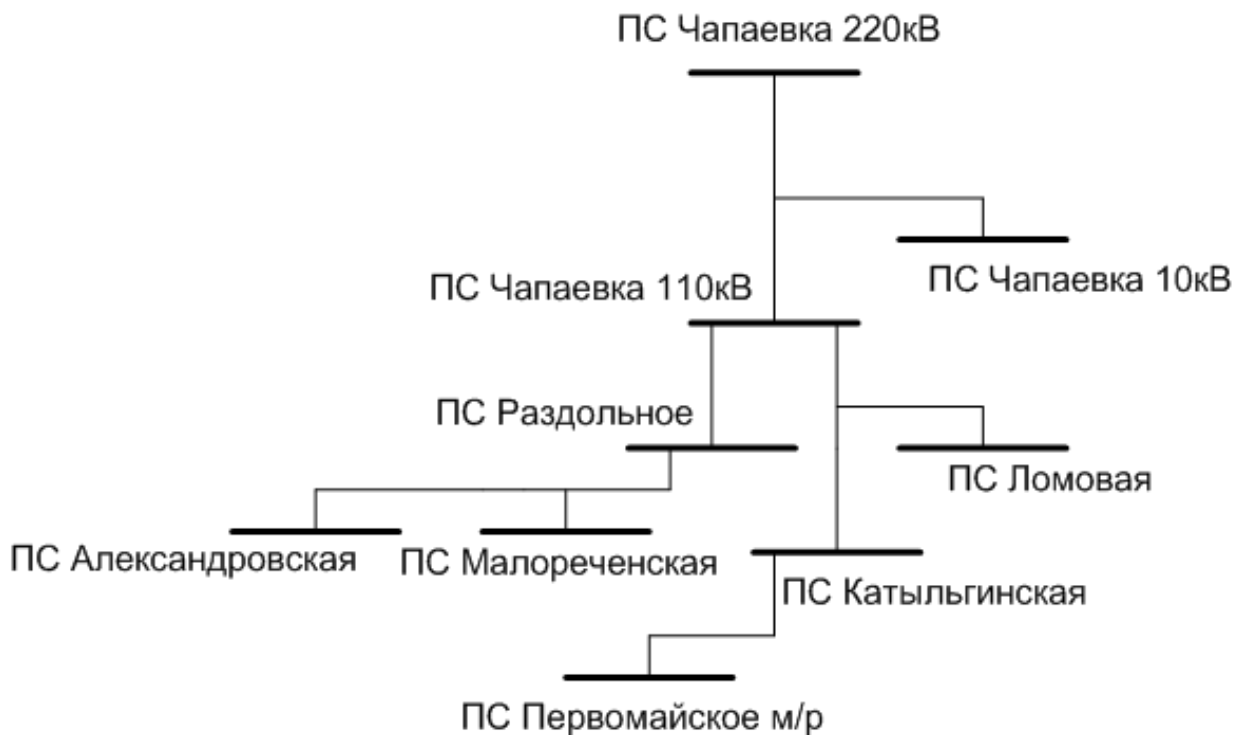
Рисунок 13 - Исходная скелетная схема
