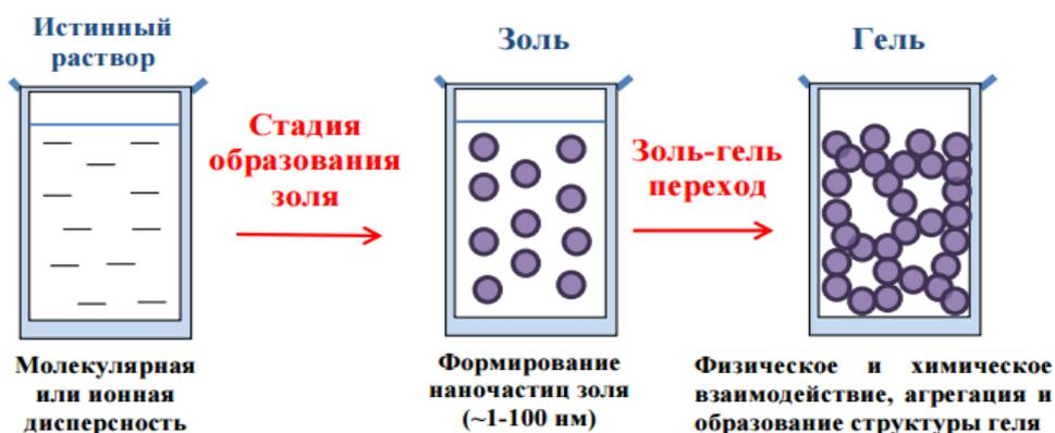
Рисунок 1.7 - Схема перехода истинного раствора в золь и далее в гель
