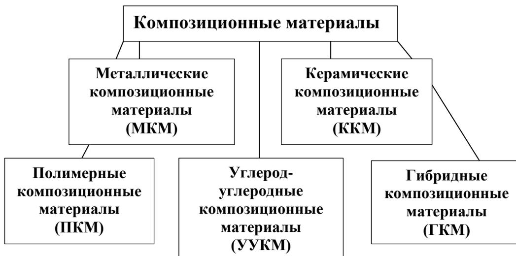
**Рисунок 1.5** - Классификация композиционных материалов
