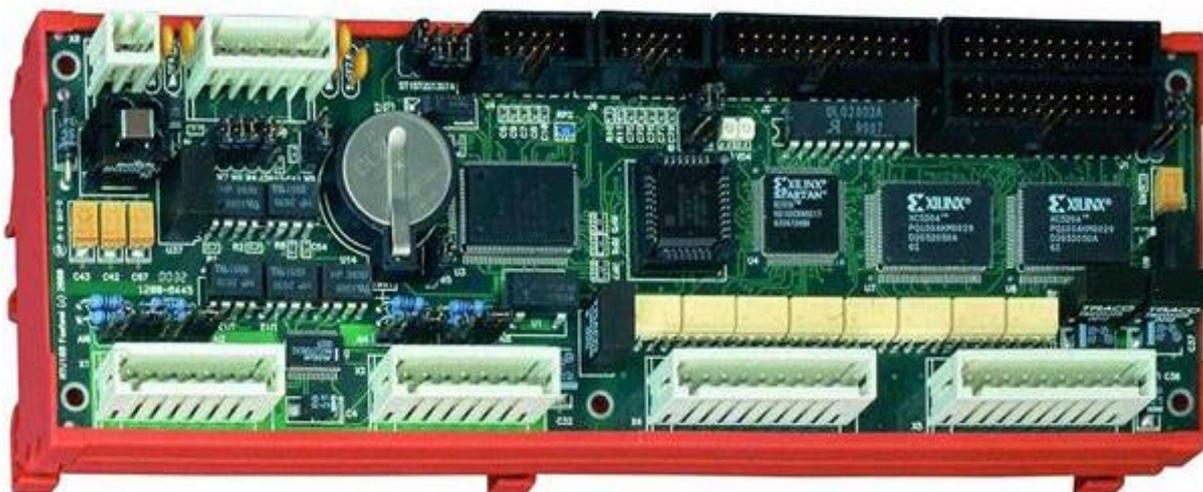
Рисунок 2.9.1 - Внешний вид модуля микроконтроллера RTU 188BS
