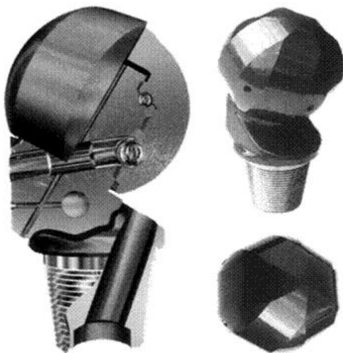
Рисунок 16 - Одношарошечные развальцеватели с герметизированной маслonaполненной опорой типа ОРШ
