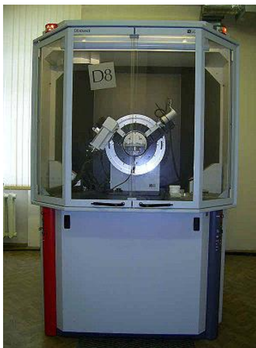
Рисунок 2.4 – Рентгеновский дифрактометр D8 Advance Bruker AXS (Германия)
