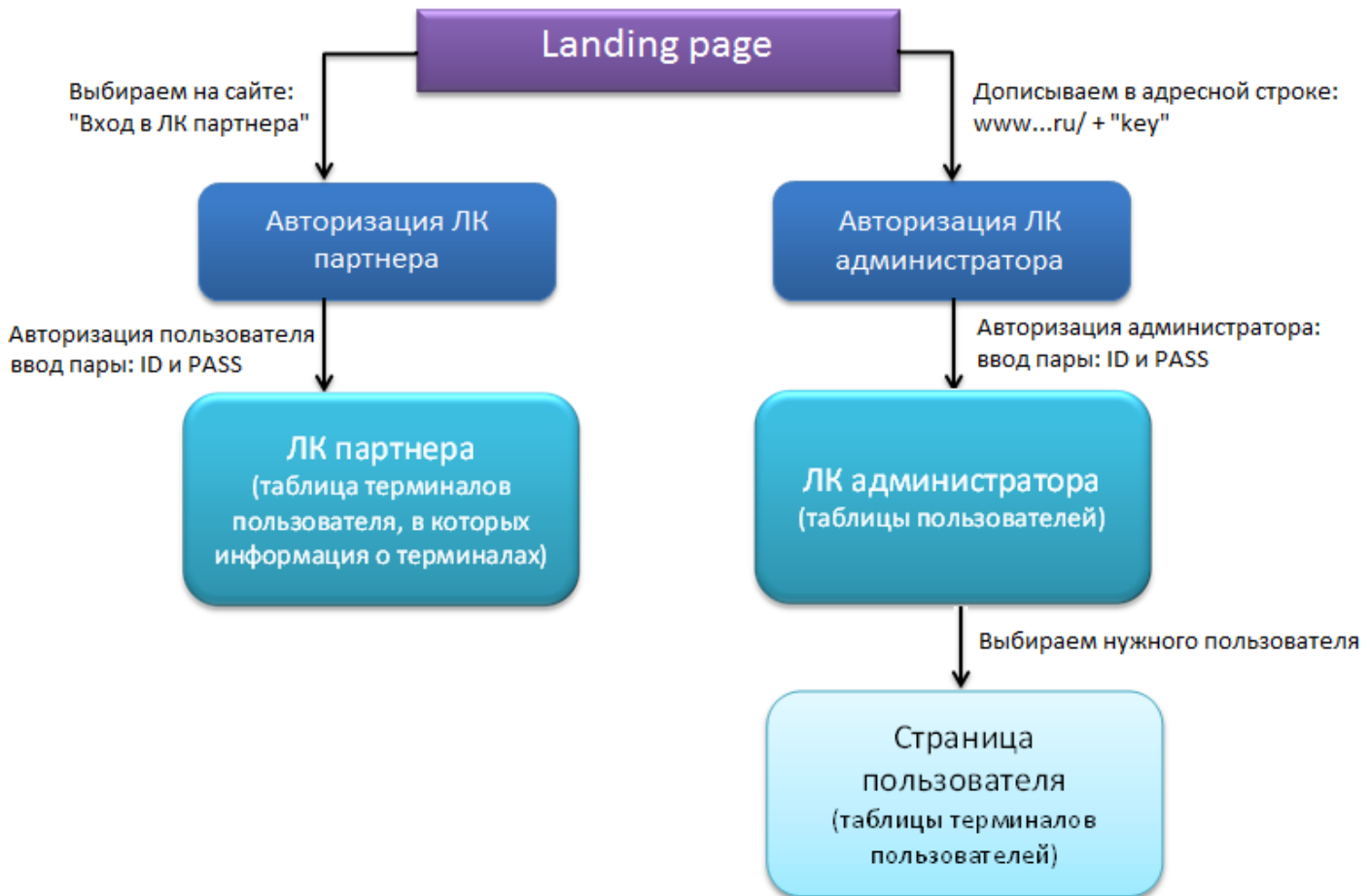
Рисунок 6. Блок-схема системы администрирования
