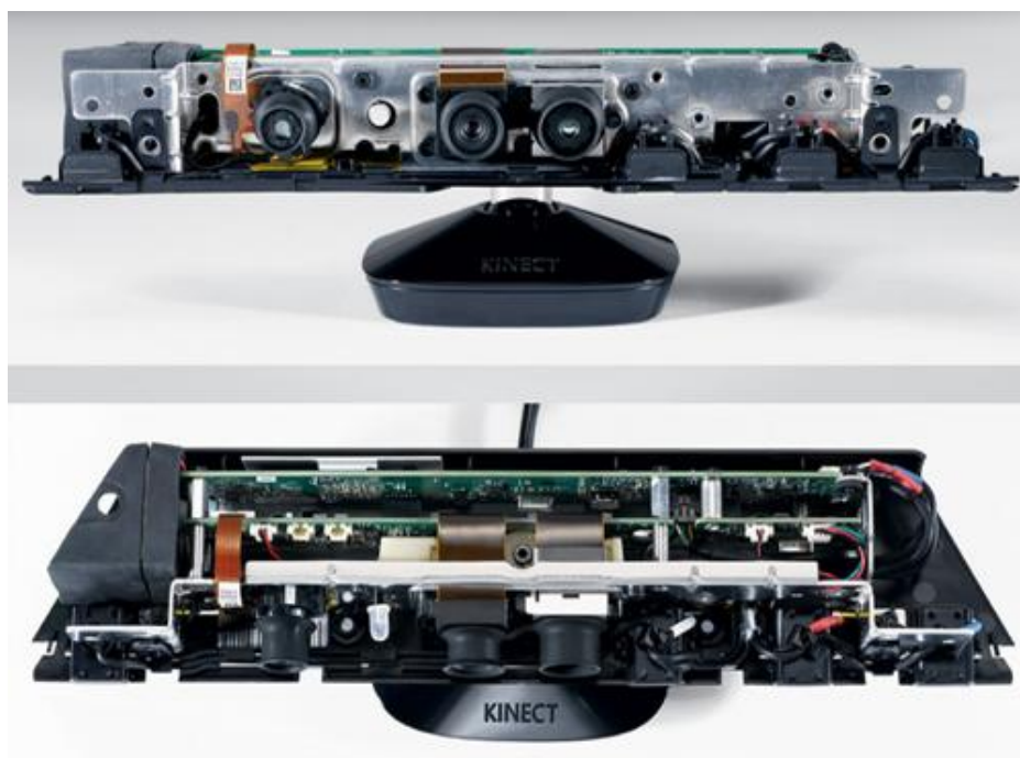
Рис. 5 – Kinect со снятой крышкой корпуса
