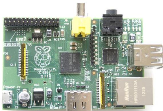
Рис.9 Плата Raspberry Pi
