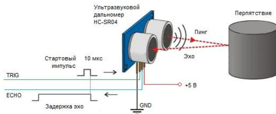
Рис.6 Пример работы ультразвукового дальномера
