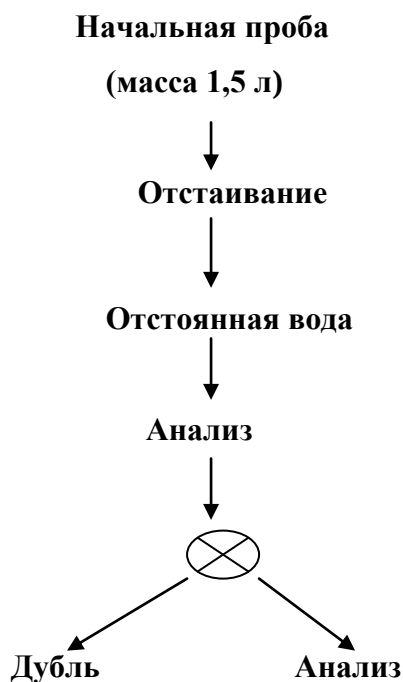
Рис.3 Схема обработки и анализа водных проб
