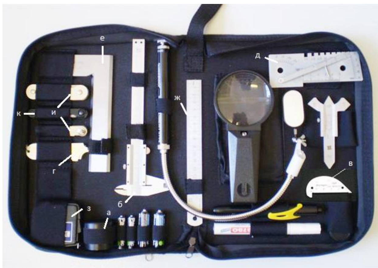
Рис 2. Комплект для визуального измерительного контроля: а - лупа измерительная ЛИ 10х; б – Штангенциркуль ШЦ-1-125-0.1; в - Универсальный шаблон Красовского УШК-1; г - Универсальный шаблон сварщика УШС-2; д - Универсальный шаблон сварщика УШС-3; е - Угольник поверочный; ж - Линейка измерительная металлическая; з – рулетка 5 м; и – наборы радиусных шаблонов №1, №3; к – Набор щупов №4;
