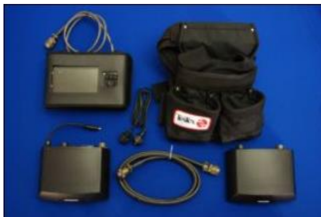
Рис. 18. Система Prodigy 8C Prodigy 8C совместима с любыми 8-ми канальными сканерами систем TS/PS.
