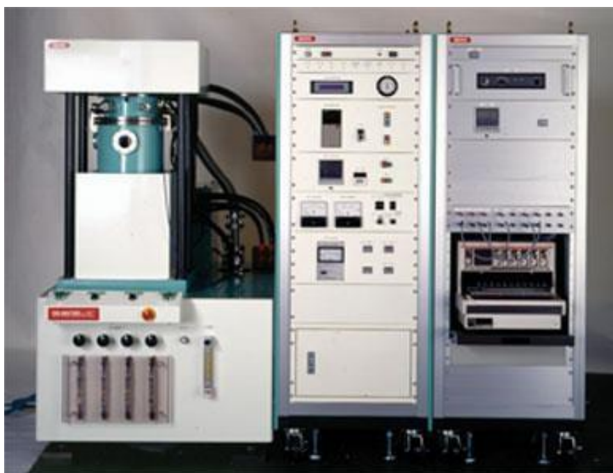
Рисунок 2.6. Установка спекания в плазме искрового разряда SPS-515S
