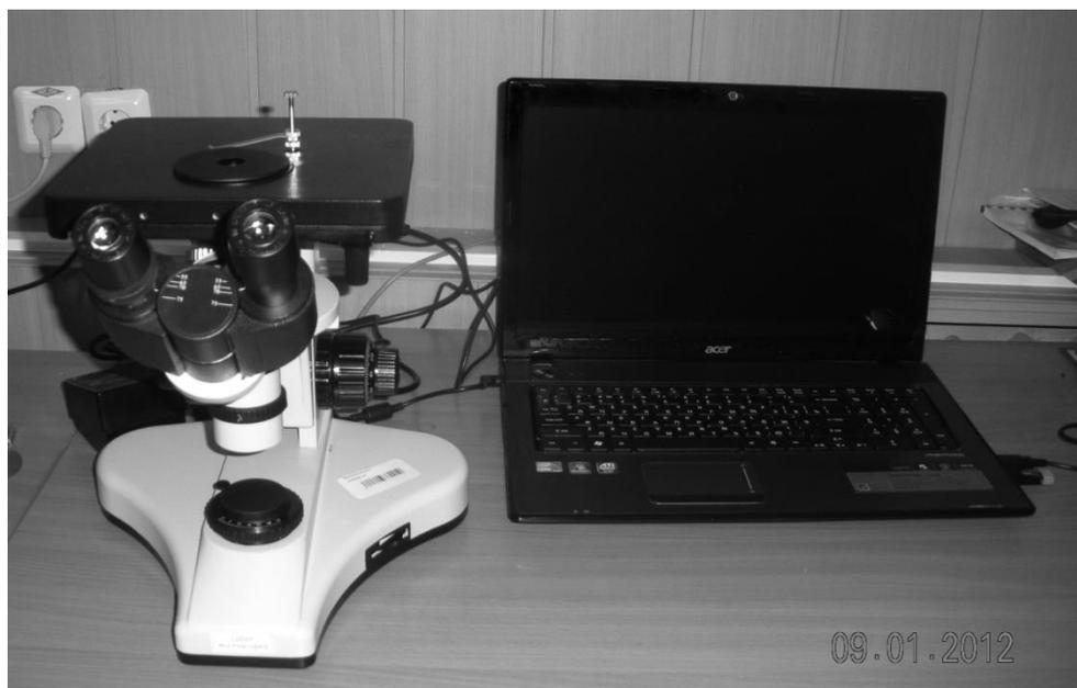
Рисунок 2.4 – Металлографический микроскоп ЛабоМет
