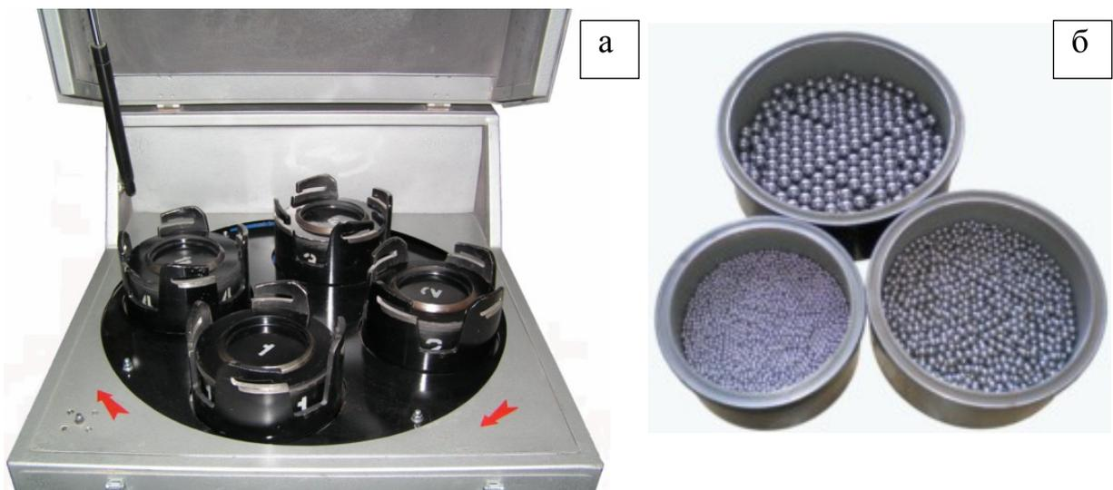
Рисунок 2.2 – Планетарная мельница: а) загрузка барабанов, б) мелющие тела (стальные шары) в барабанах (три различных размера)
