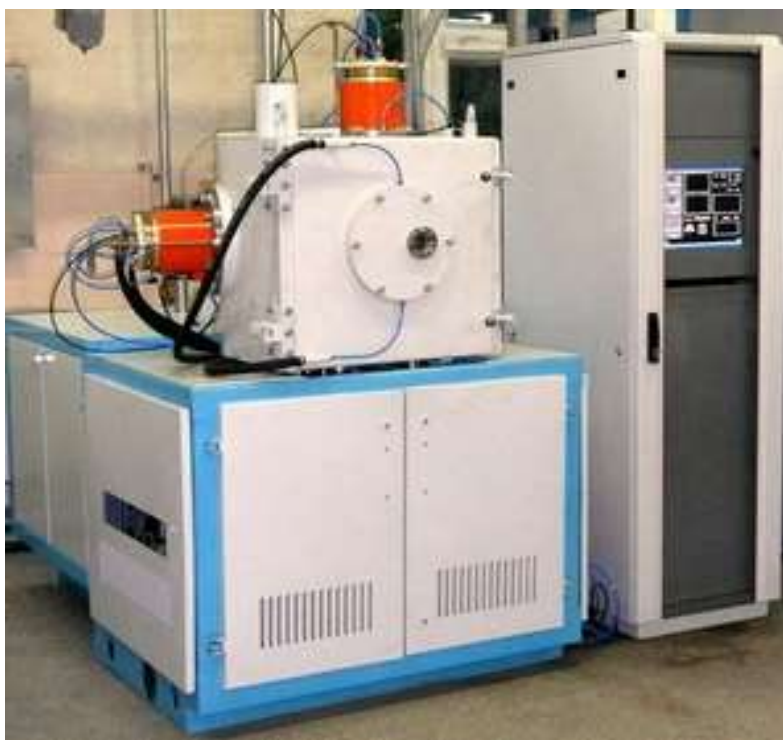
Рисунок 20 – Внешний вид установки ННВ-6.6-И1, дооснащенной плазмогенератором «ПИНК»
