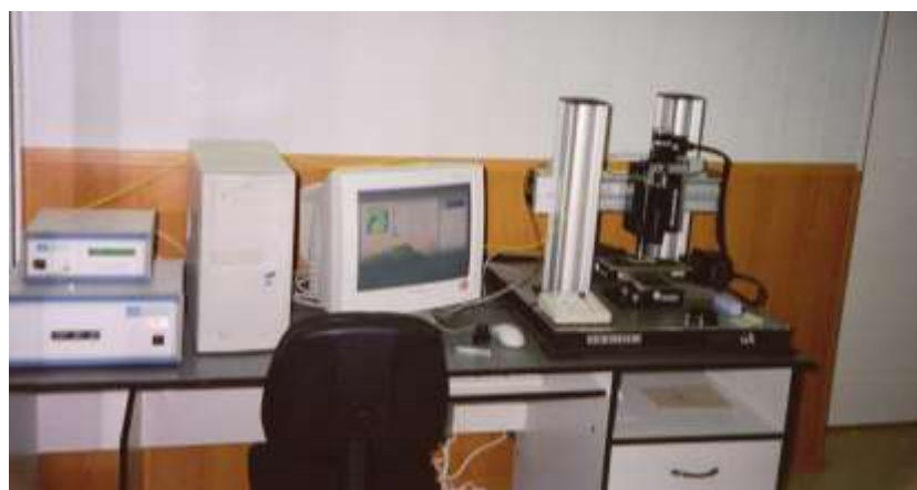
Рисунок 17 – Внешний вид профилометра MICRO MEASURE 3D Station французской фирмы STIL
