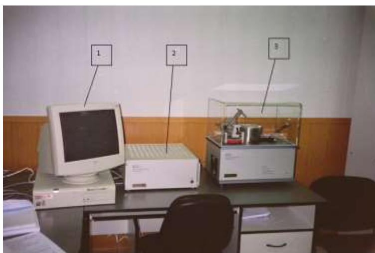
Рисунок 16 – Внешний вид высокотемпературного трибометра: 1 - персональная электронно-вычислительная машина, отвечающая за интерфейс управления и обработку, визуализацию и хранение данных исследования; 2 - блок управления обработкой сигналов с измерительных датчиков; 3 - высокотемпературный трибометр
