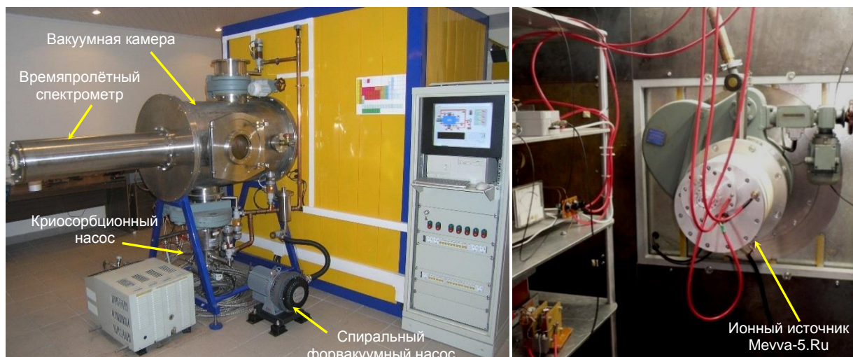
Рисунок 2.1 – Фотографии экспериментальной установки (слева) и ионного источника (справа).
