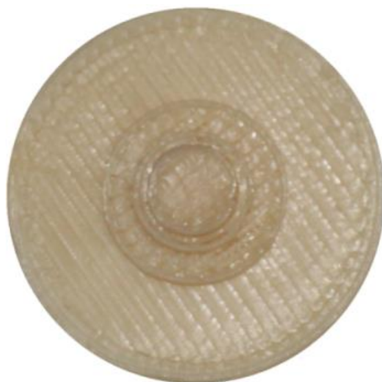
Рисунок 3.7 – Внешний вид фильтрующего элемента из АБС пластика
