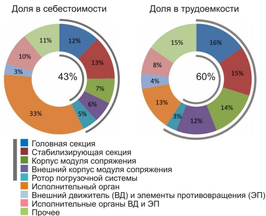
Рис. 1.4 Доли в себестоимости и трудоемкости изготовления различных узлов и систем гехода
