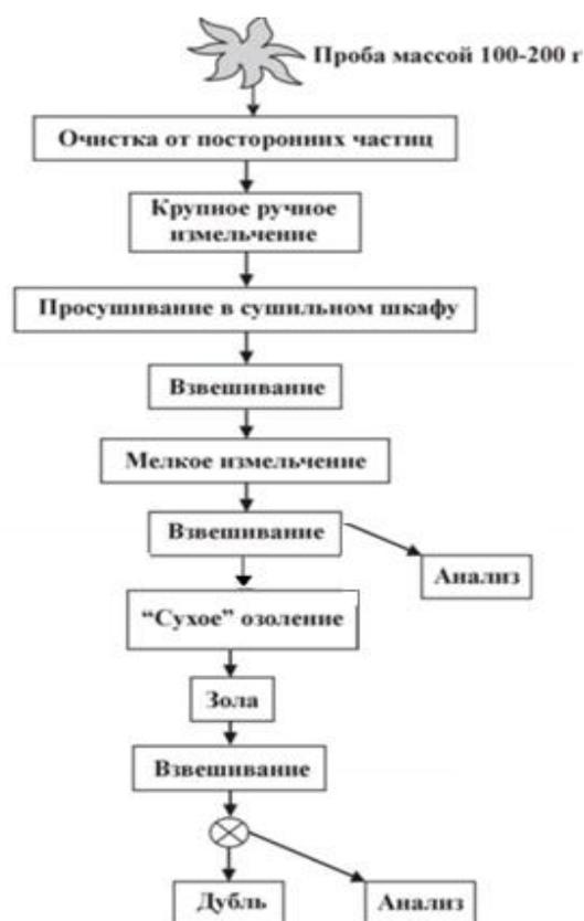
**Рис. 10** Схема пробоотбора проб растительности [57]
