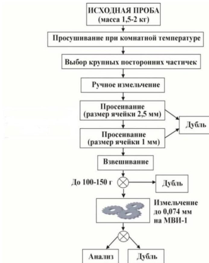
**Рис. 9** Схема пробоподготовки проб почвы [57]
