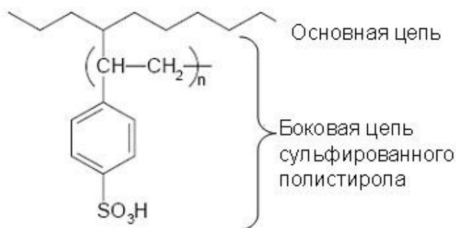
Рисунок 4 – Полимерный скелет – ПВДФ, боковая цепь – сульфированный полистирол
