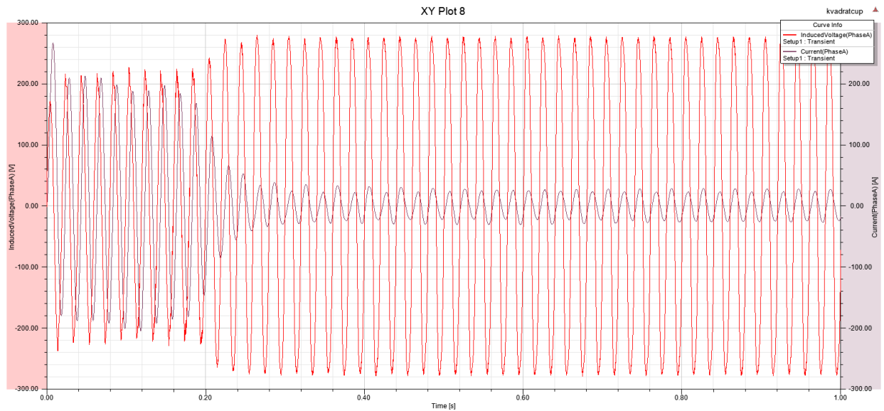
Рисунок 42 - График тока и напряжения обмотке статора
