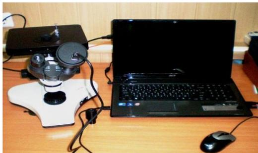
Рисунок 4- Оптический микроскоп «Лабомет-И»
