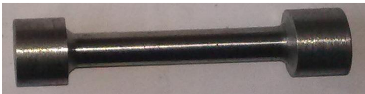
Рисунок 3 – Чертеж (а) и внешний вид образца (б) для механических испытаний на статическое растяжение
