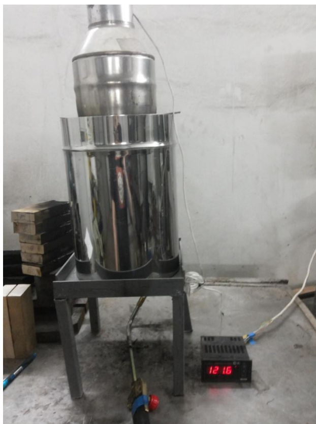
Рисунок 3 – Стенд для определения огнезащитной эффективности покрытий и пропиток
