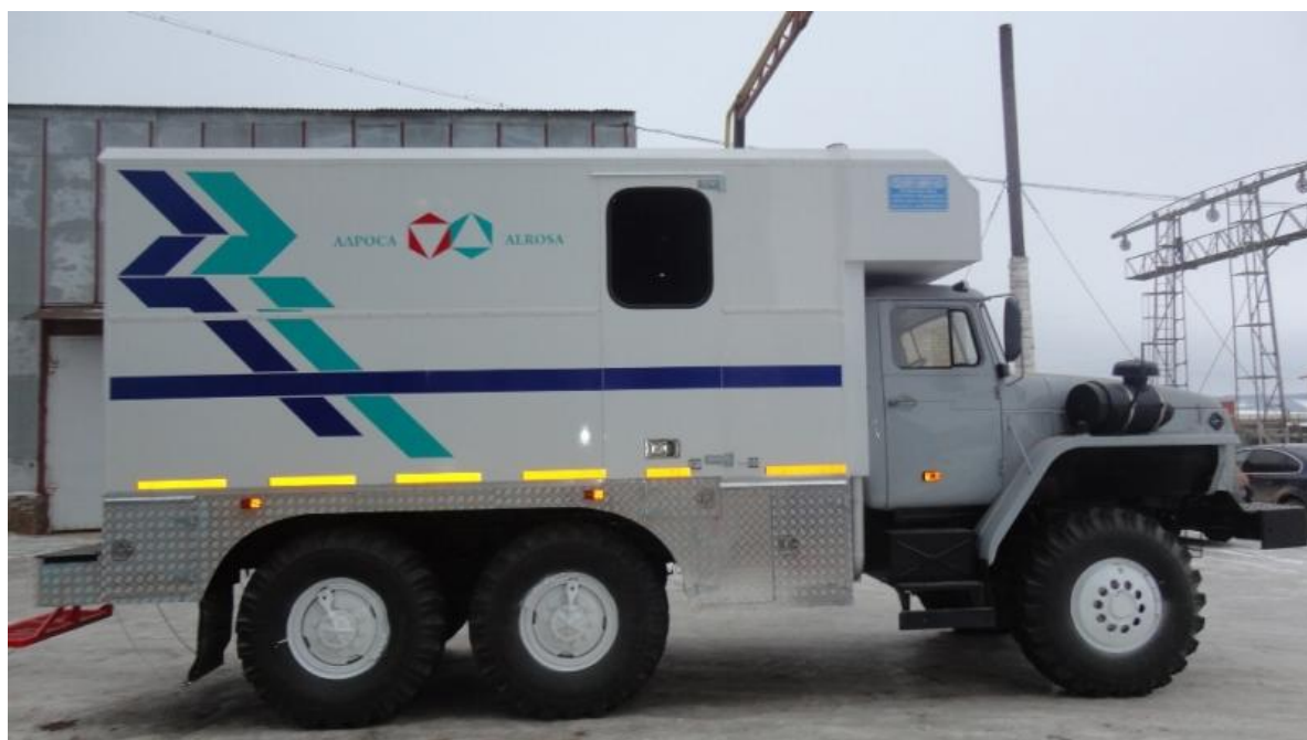
Рисунок 9 – Каротажная станция КАМК "Алмаз-1" на шасси автомобиля "УРАЛ-4320"
