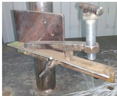
Рисунок 2 – Приспособление для сварки труб малого диаметра в горизонтальном положении
