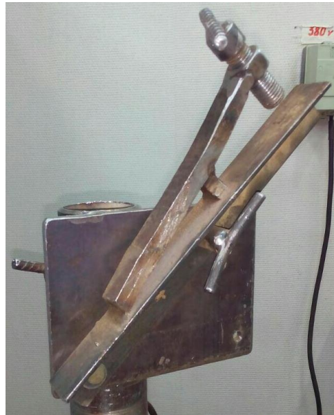
Рисунок 1 – Приспособление для сварки труб малого диаметра в положении под углом 45^\circ
