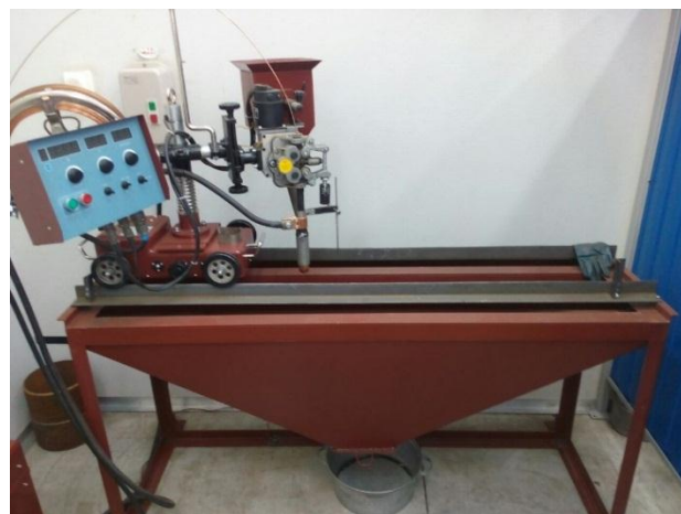
Рисунок 3 – Аппарат для проведения сварки под слоем флюса
