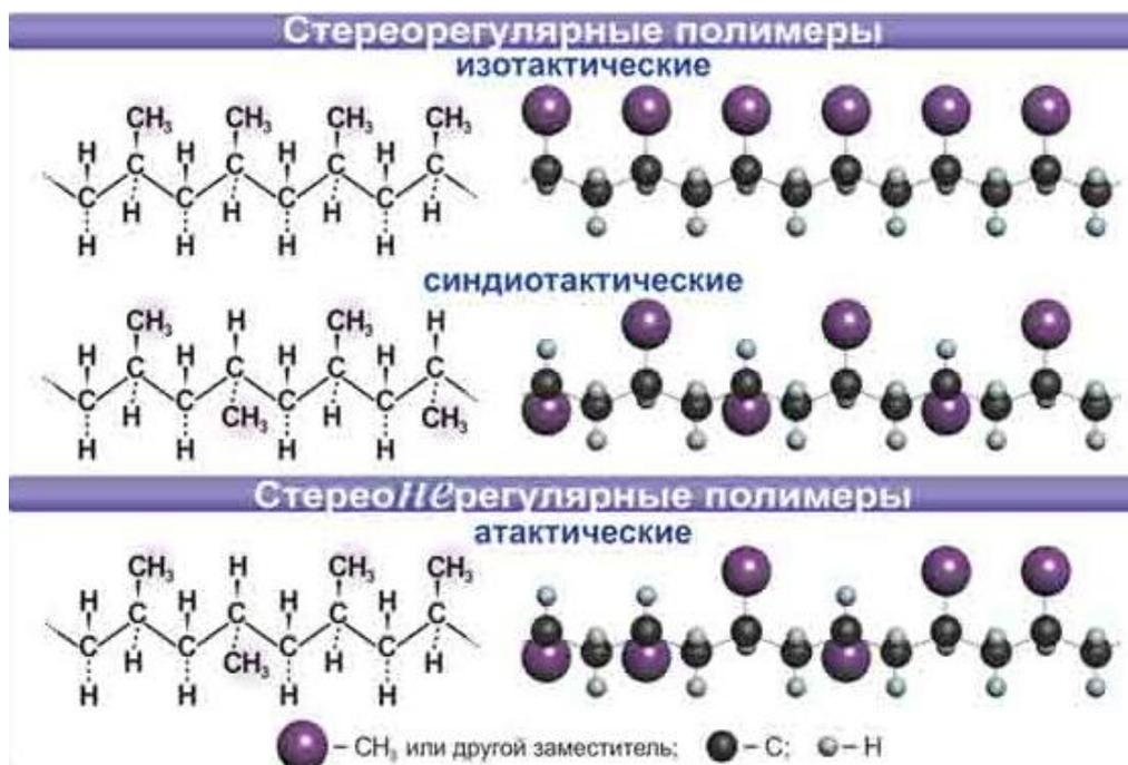
Рисунок 4 – Классификация полимеров по строению макромолекулы
