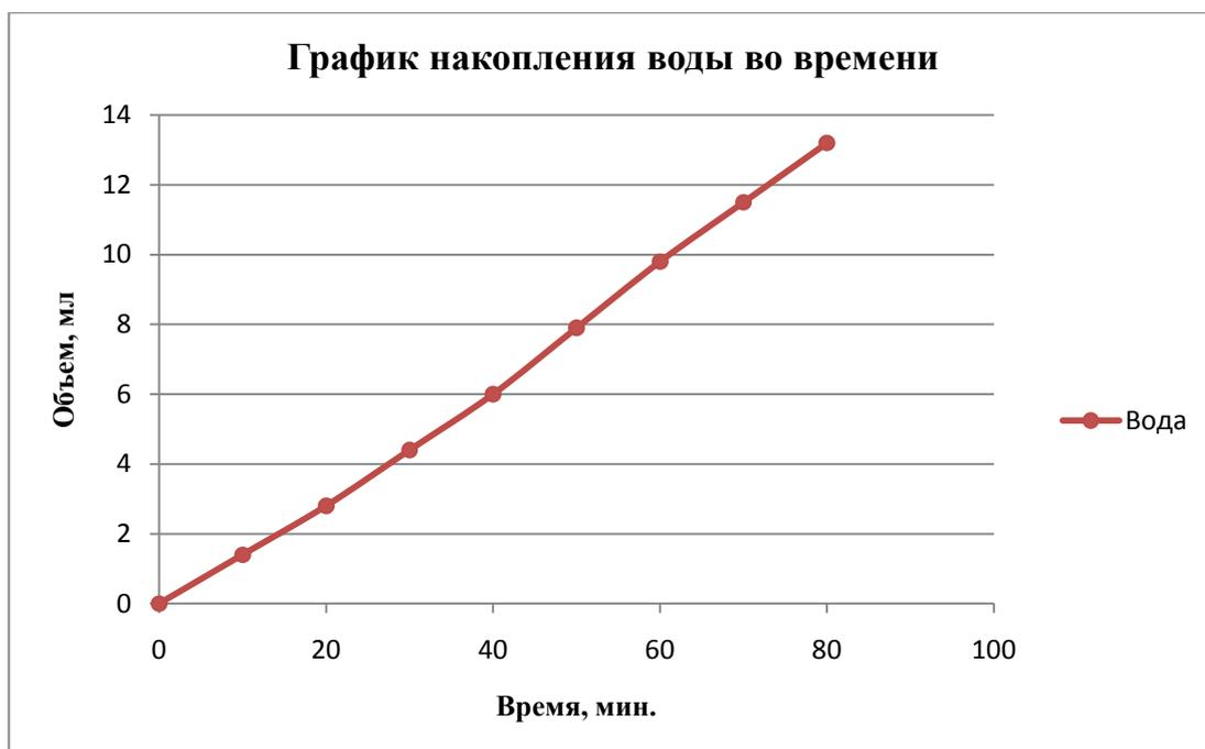
Рисунок 41 – График накопления воды во времени (без растворителя)
