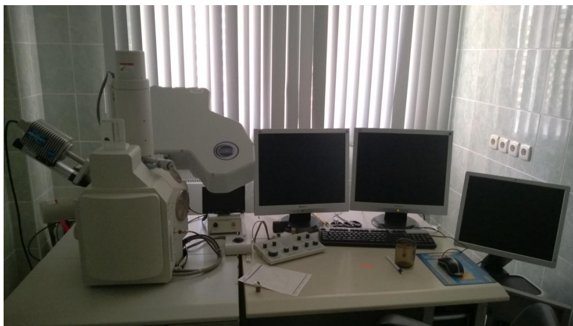
Рисунок 13. Растровый электронный микроскоп Hitachi S-3400N
