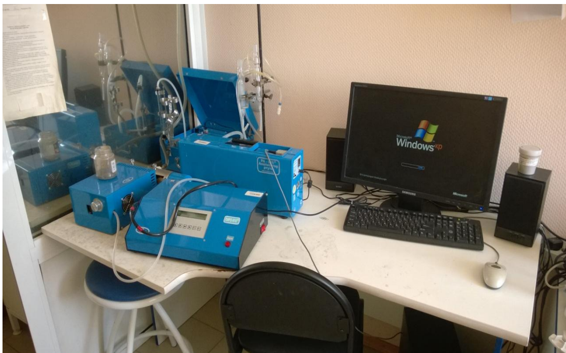
Рисунок 16. Ртутный анализатор РА-915+ с пиролизической приставкой ПИРО-915+.
