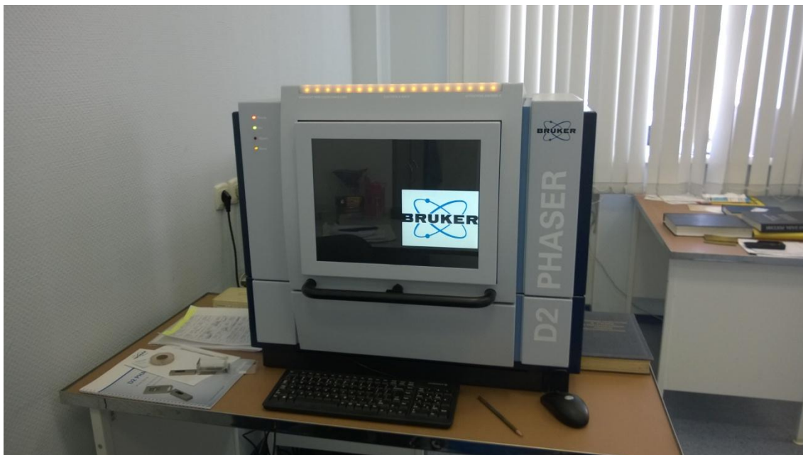
Рисунок 9. Дифрактометр D2 Phaser.
