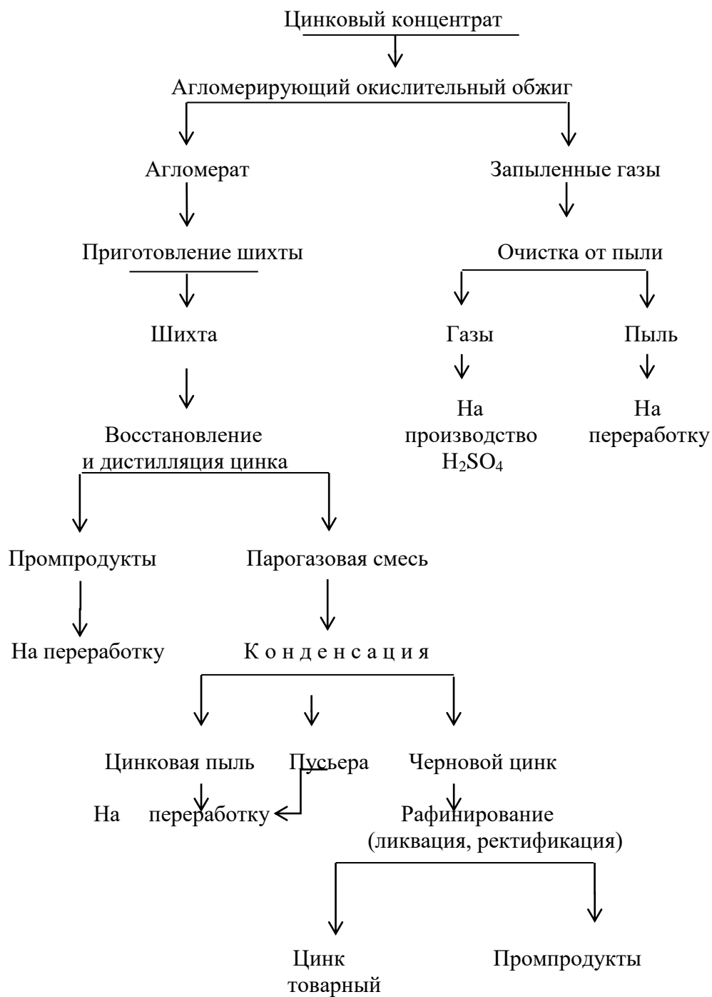
Рисунок 1.1 - Технологическая схема пирометаллургического способа переработки цинковых концентратов
