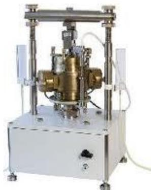
*Рис. 3.5. Сдвиговой прибор ИВК «АСИС»*
