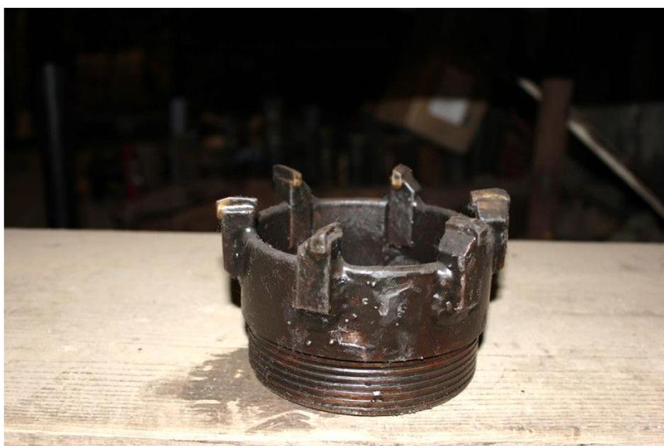
*Рис. 3.2. Коронки типа М1*
