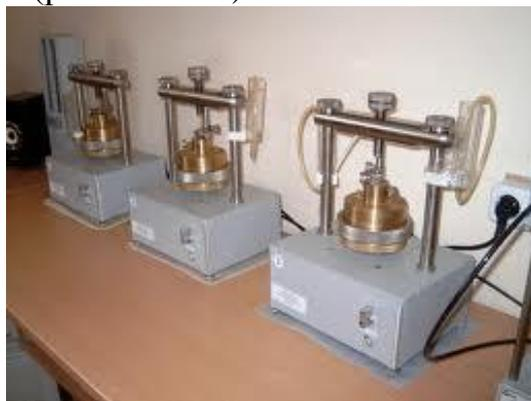
*Рис. 3.6. Компрессионный прибор ИВК «АСИС»*
