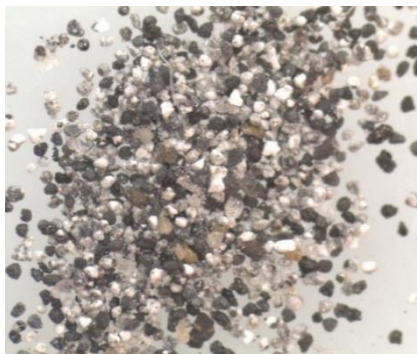
Рис.43. Общий вид пробы твердого осадка снега под бинокулярным микроскопом при увеличении 25х (размер частиц 0,125 мм)
