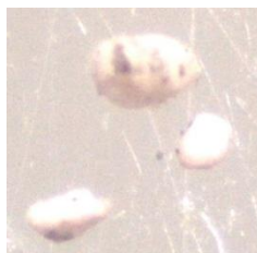
Рис.15. Частицы полевого шпата (предположительно альбит) под бинокулярным микроскопом, увеличение 35 x
