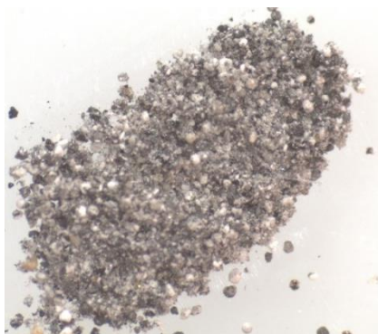
Рис.44. Общий вид пробы под бинокулярным микроскопом при увеличении 25х (размер частиц 0,04 мм)
