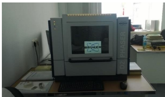
Рис.11. Дифрактометр Bruker D2 PHASER и кювета с пробой твердого осадка снега
