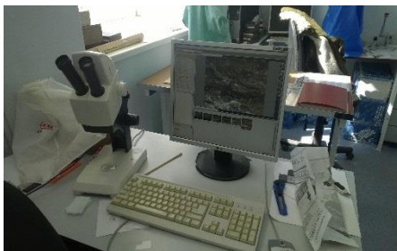
Рис. 9. Исследование вещественного состава проб твёрдого осадка снега на бинокулярном стереоскопическом микроскопе марки Leica ZN 4D
