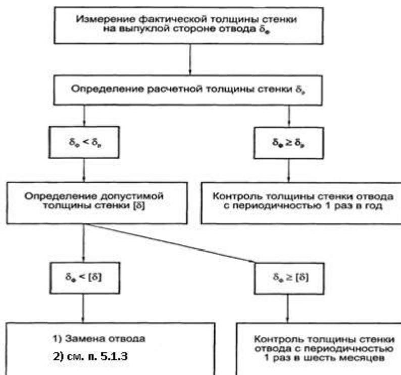
Рисунок 16 – Алгоритм оценки работоспособности отводов с эрозионным утонением стенки
