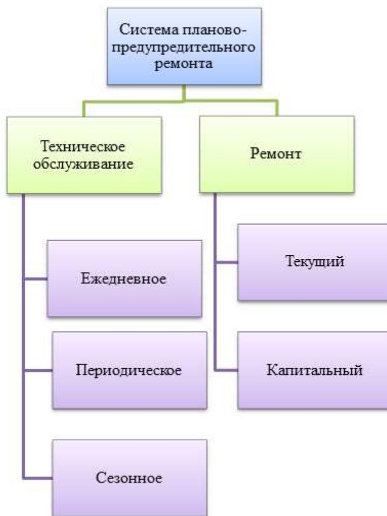
Рисунок 4 – Принципиальная схема системы ППР
