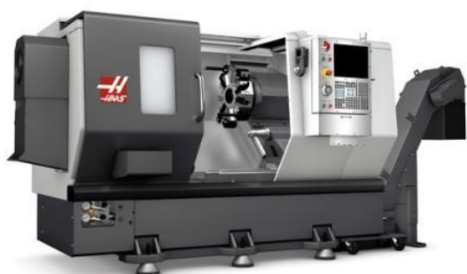
Рис.2.8. Токарно-револьверный станок с ЧПУ HAAS ST-20
