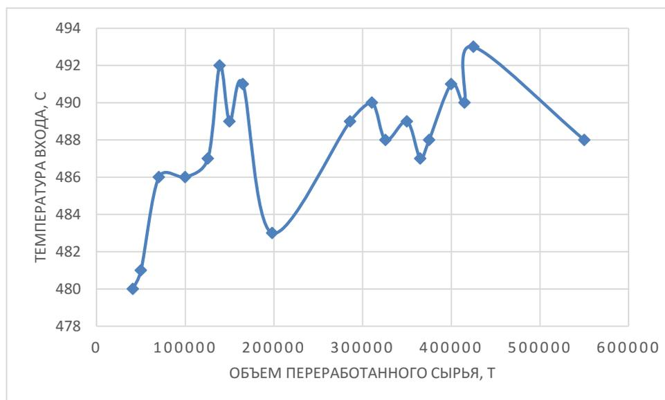
Рисунок 3.5 - Изменение входной температуры от объема переработанного сырья
