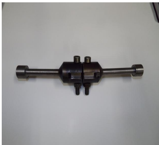
Рисунок 2.6 – Испытуемый образец в захватах
