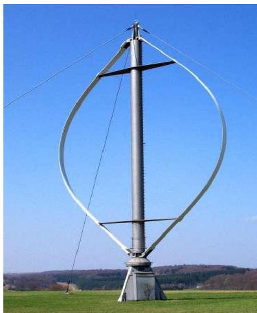
Рисунок 10 – Вертикальный ветрогенератор
