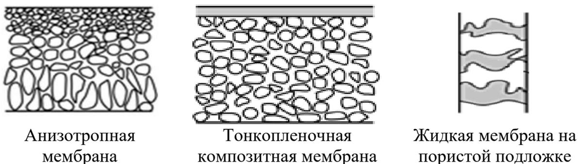
Рисунок 2 - Схематическое изображение структуры ассиметричных мембран
