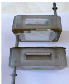
Рисунок 14 - Фотография сконструированной ячейки для травления
