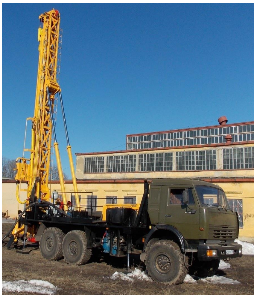
Рисунок 3.1 – Буровая установка УРБ-210
