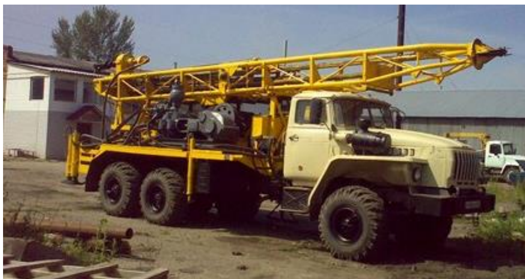
Рисунок 2.4 – Буровая установка УБР-12
