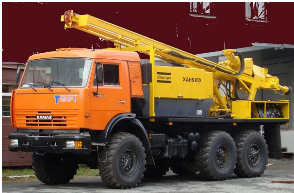
Рисунок 3.3 – Буровая установка УРБ-2А2Д
