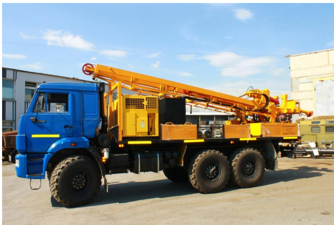
Рисунок 2.3 – Буровая установка УРБ-2А2
