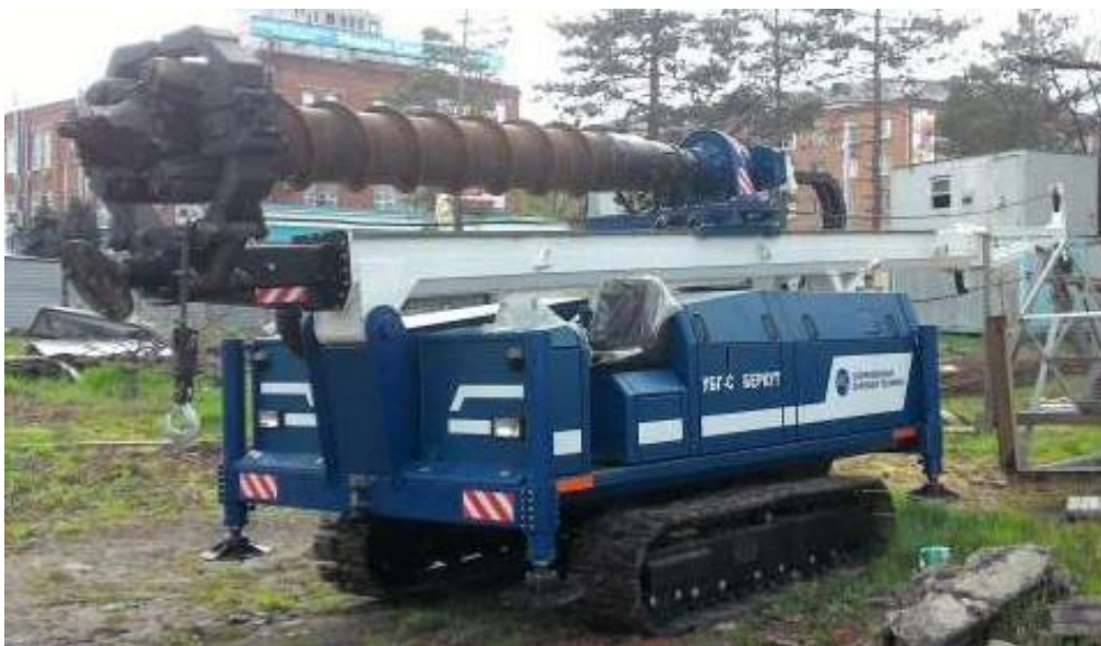
Рисунок 2.10 – Буровая установка УБГ-С-30 «Беркут»
