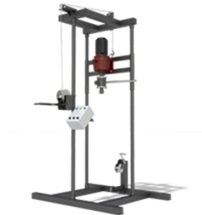
Рисунок 1.13 – Буровая установка РБ-50/380
