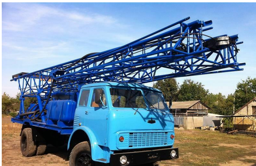
Рисунок 3.5 – Буровая установка УРБ-3А3
