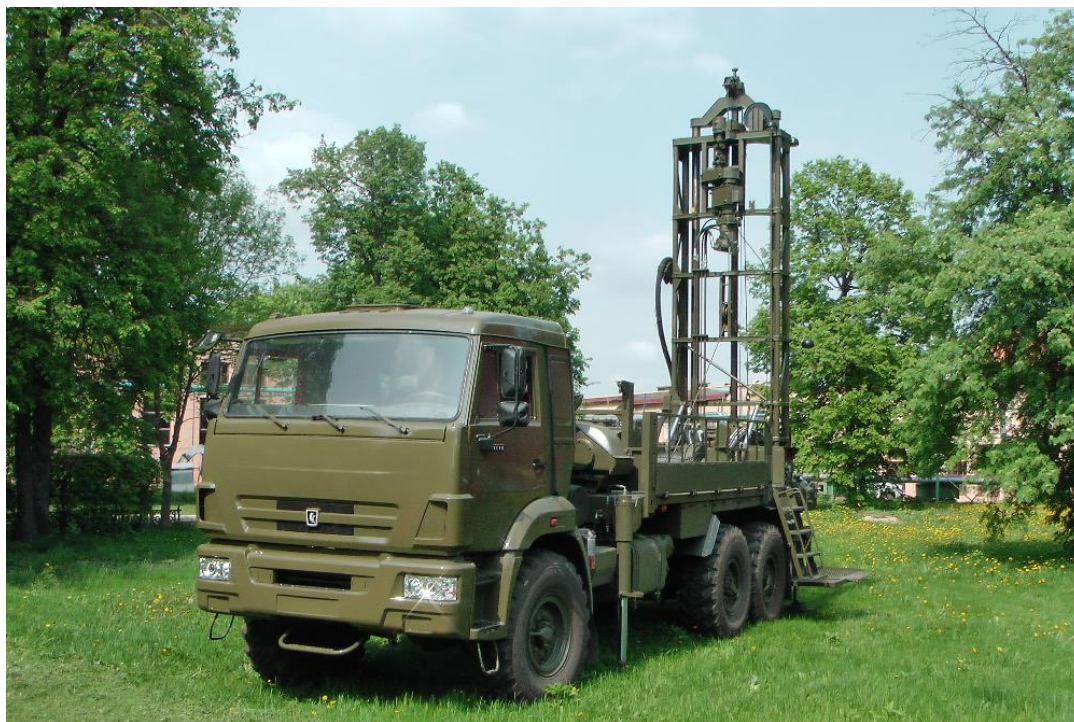
Рисунок 1.3 – Буровая установка ЛБУ-50
