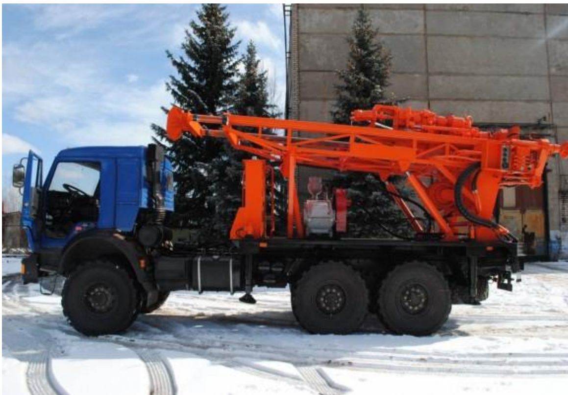
Рисунок 3.8 – Буровая установка МБУ-20АГ
