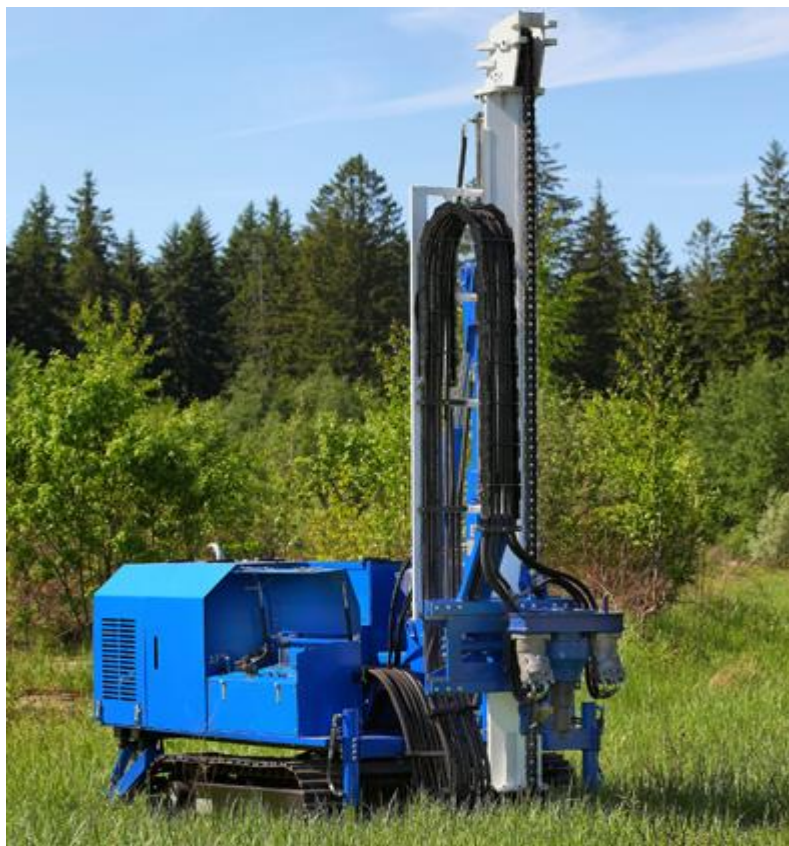
Рисунок 2.9 – Буровая установка УБГ-Л-20 «Мангуст»
