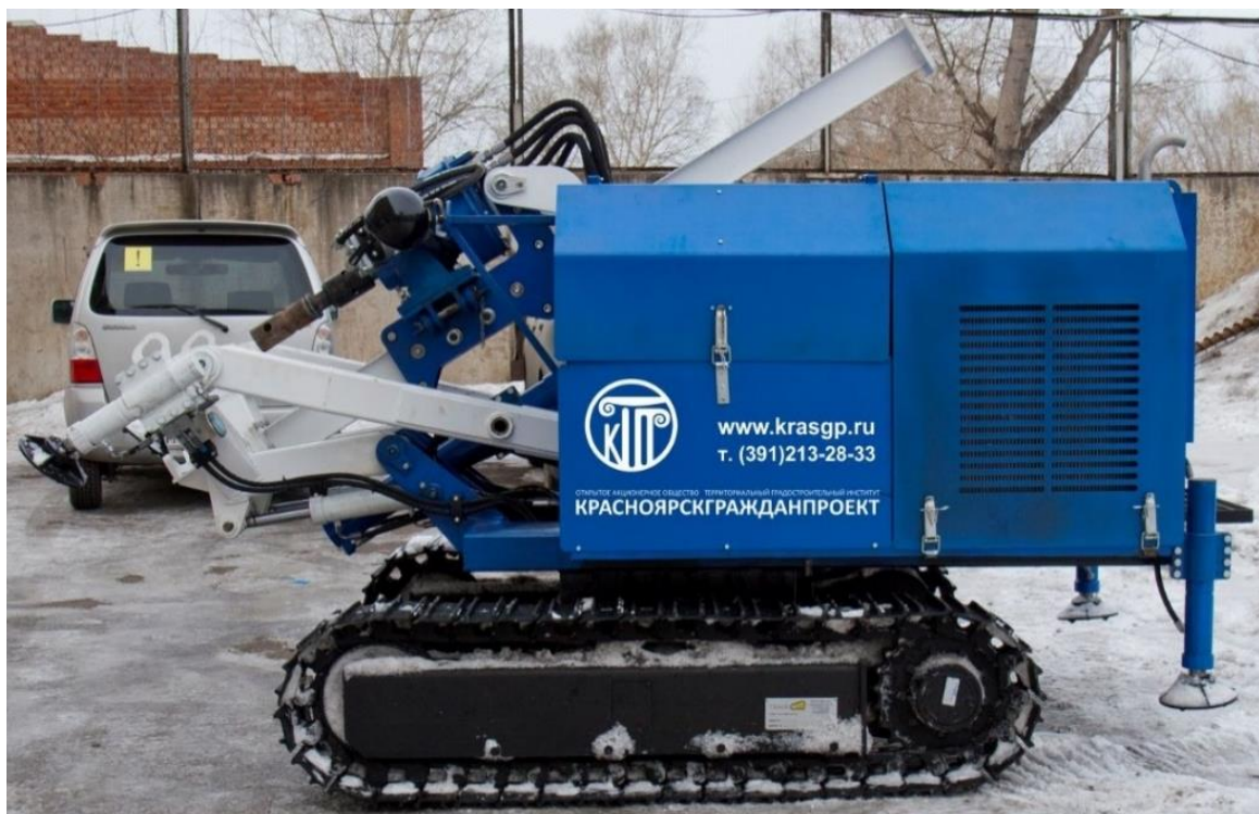
Рисунок 1.12 – Буровая установка УБГ-Л-10 «Аллигатор»
