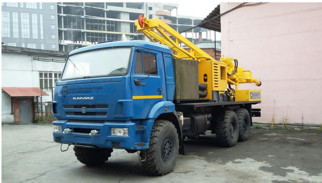
Рисунок 2.5 – Буровая установка УРБ-2Д3
