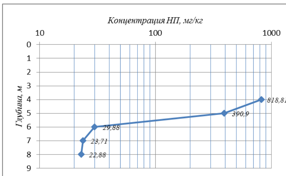
Рис. 7 График изменения содержания нефтепродуктов в грунтах по разрезу (АЗС-24) по данным скв. №7 [70].
