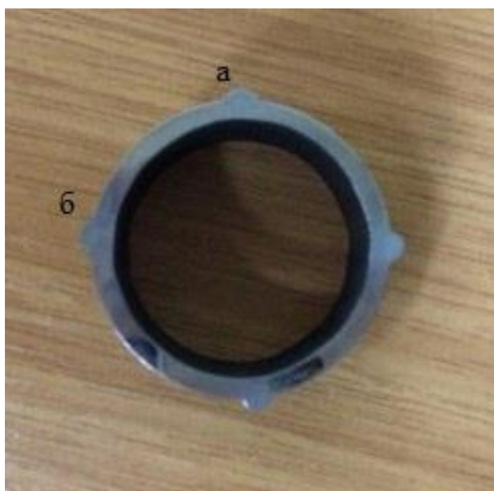
Рисунок 3.2 – Трубная заготовка с наплавленным металлом а) на постоянном токе обратной полярности, б) на переменном прямоугольном токе
