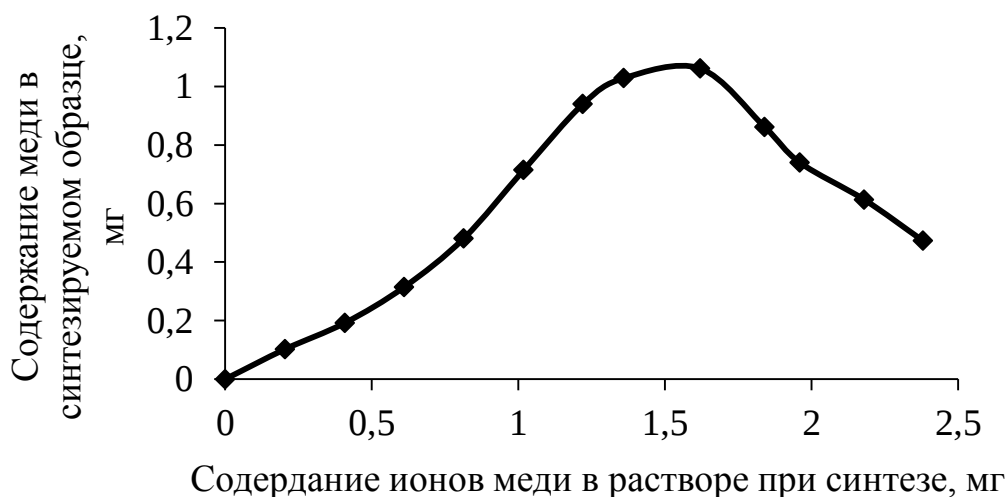
Рисунок 31 – Зависимость содержания ионов меди в образцах от их содержания в растворе при синтезе
