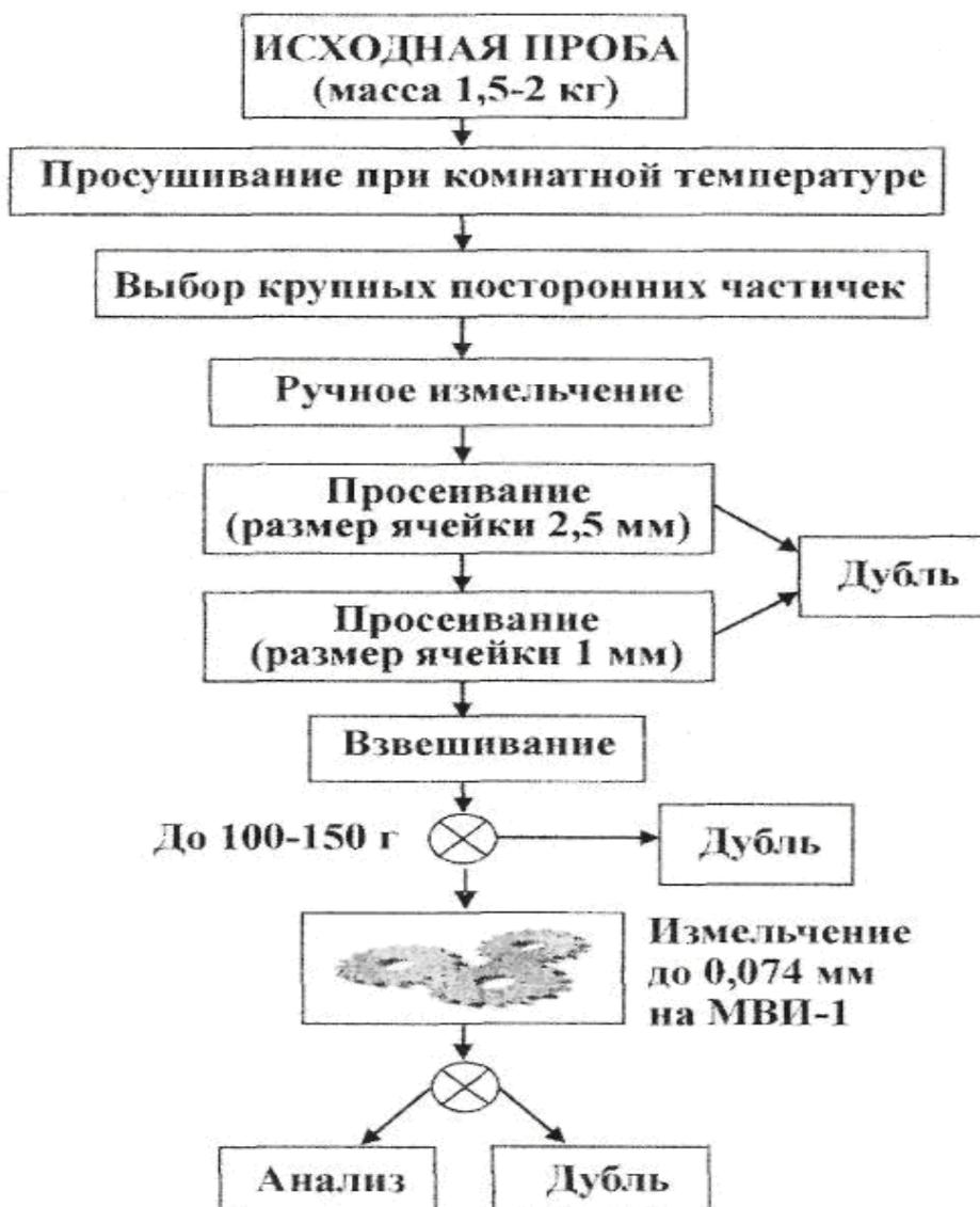
Схема обработки и изучения проб почв
