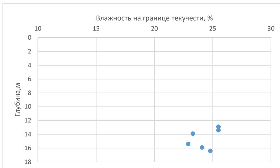
*Рис. 2.10 График изменчивости влажности на границе текучести супеси пластичной по глубине.*
