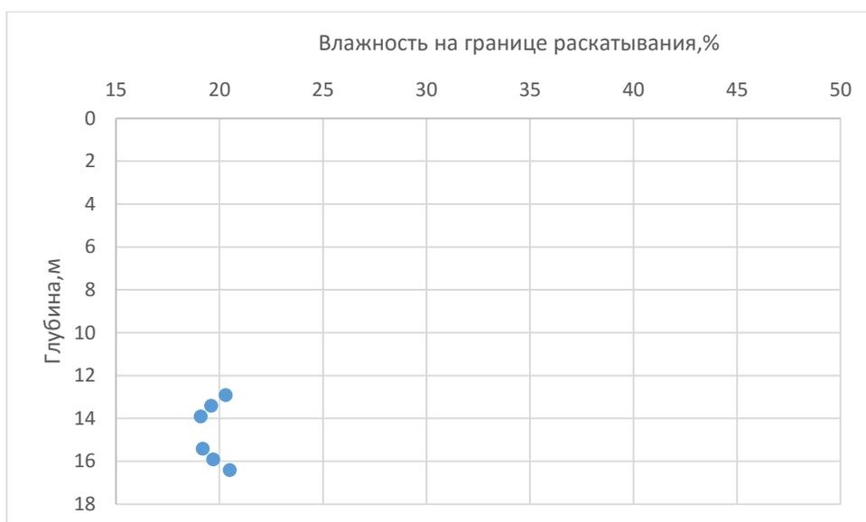
*Рис. 2.11 График изменчивости влажности на границе раскатывания супеси пластичной по глубине.*
