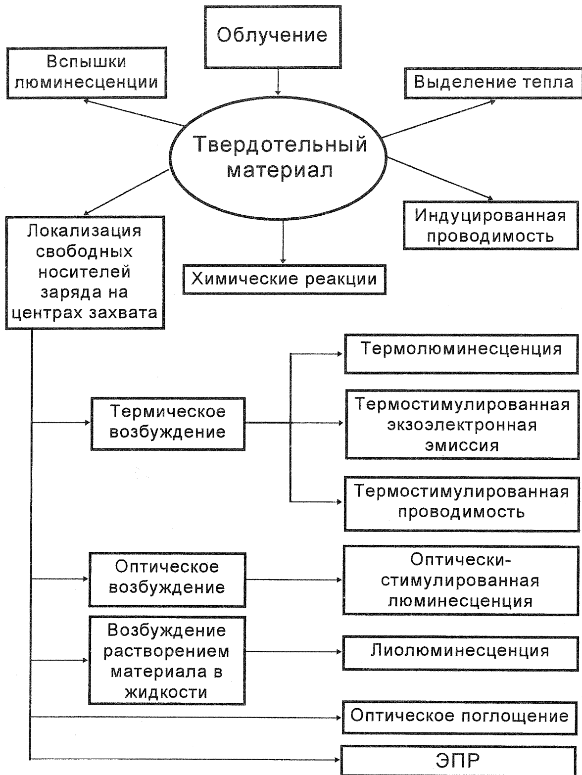
Рис.1. Физические процессы в облученных твердых телах и их возможные применения в дозиметрии.
