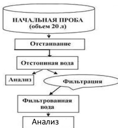
Рисунок 10 Схема обработки и анализа проб поверхностных вод [3]
