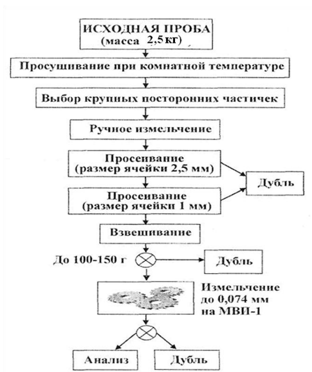
Рисунок 11- Схема обработки и анализа проб донных отложений [3]
