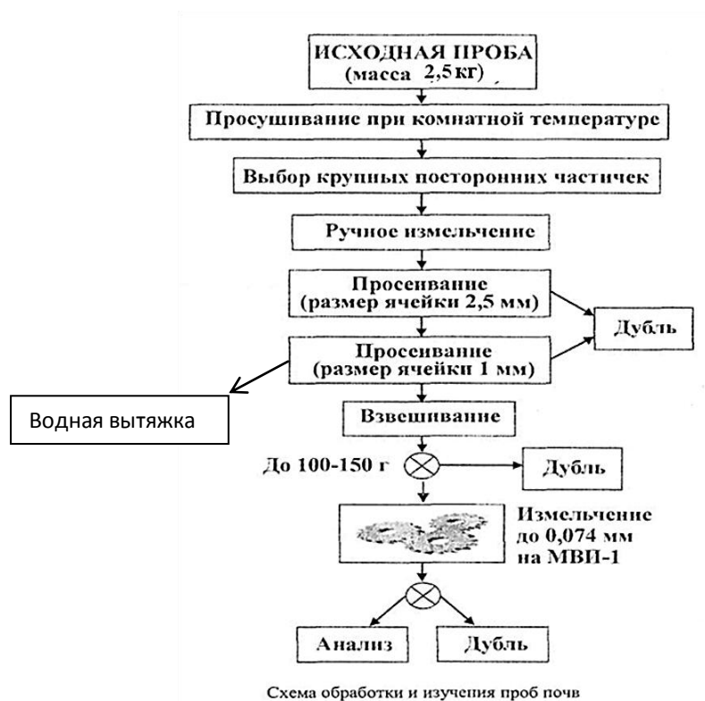
Рисунок 7 - Схема обработки и изучения проб почвы [3]
