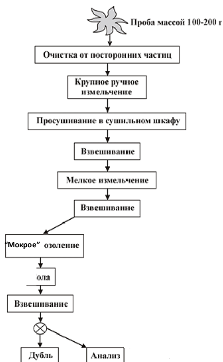
Рисунок 12 - Схема обработки и изучения проб растительности [18]
