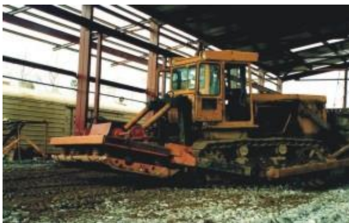
Рисунок 4 – Бульдозер Б – 170 с навесным виброуплотнителем ВУ
