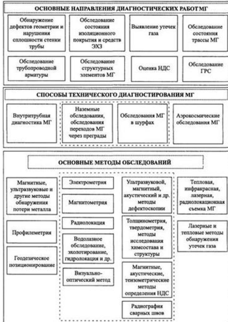
Рисунок 3.1 - Структурная схема диагностических работ на МГ
