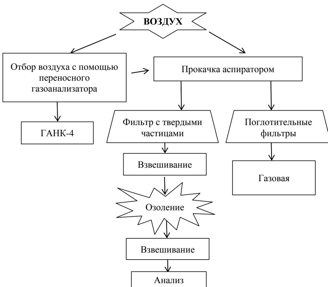
Рисунок 2 – Схема обработки и изучения проб атмосферного воздуха [14].
