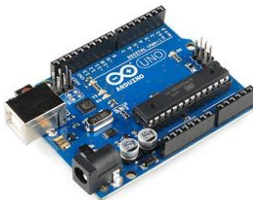
Рисунок 1.2 – Внешний вид контроллера Arduino Uno
